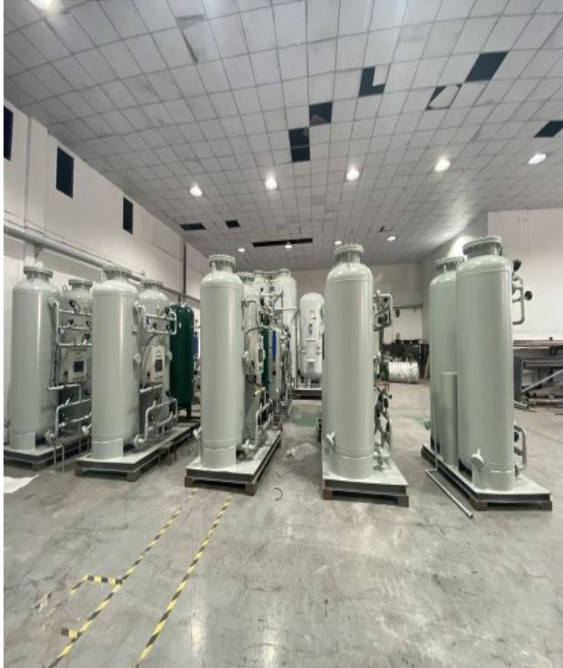
变压吸附（PSA）是用于工业和医疗应用的现场制氮的广泛应用技术之一。PSA 制氮机由两个充满碳分子筛的吸附器组成，具有从压缩空气中吸附氧气的 ability。PSA 工艺的工作原理是吸入环境空气，然后对其进行过滤和压缩。氧气被吸附在碳分子筛中，而富含氮气的气体则通过吸附器移动。该工艺有能力将氧气浓度降低到所需规格。
