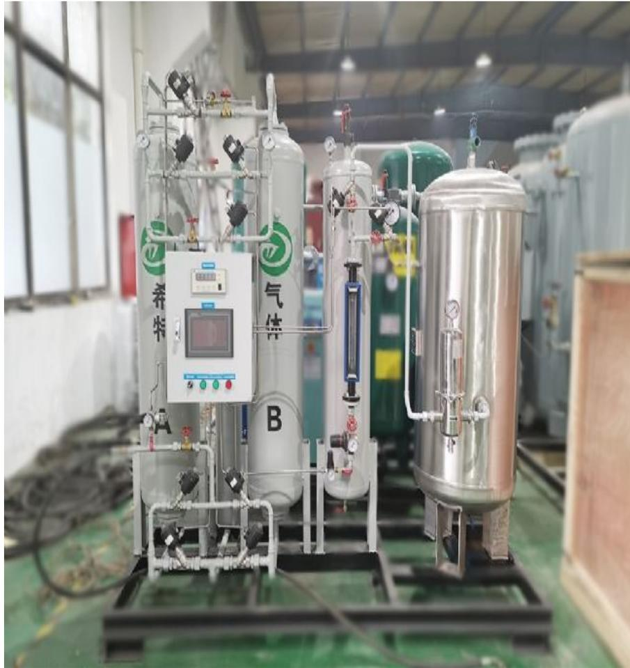
PSA 制氮机设备通常由两个塔式系统组成，每次都充满了特殊类型的 CMS。在变压吸附（PSA）技术的帮助下，我们生产出高度经济和高性能的氮气设备。这两个塔在氮气生产和再生过程中工作。氮气是在压缩空气通过碳分子筛（CMS）的过程中产生的。在这个过程中，水分、氧气分子和其他气体被吸收，而氮气则不被吸收而直接流出。然后，氮气被收集在一个浪涌容器中。
