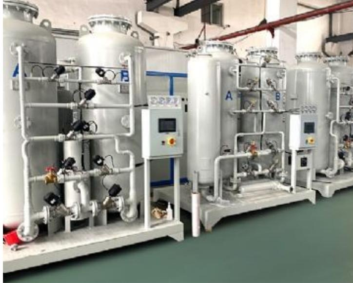
考虑购买氮气发生器的公司应该考虑他们需要什么纯度的氮气。氮气纯度通常以百分比的形式表示。例如，99% 的氮气表示气体由 1% 的氧气组成，其余 99% 由氮气和其他惰性气体组成。
