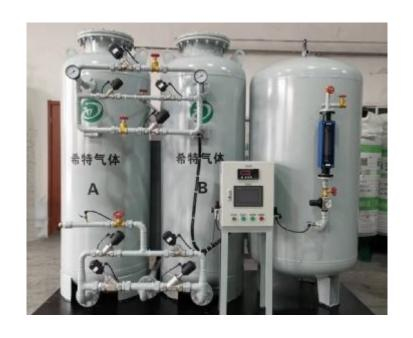
吸附是物质(本例中为压缩空气)中的原子、离子或分子粘附在吸附剂表面的经过。 变压吸附(PSA)发生器将氮气隔离,压缩空气流中的其他气体(含氧量、二氧化反 应碳和水蒸气)被吸附,基本上留下纯氮气。当分子与专用碳分子筛结合时,变压吸 附(PSA)会从压缩空气流中捕获含氧量。这种情况发生在两个单独的压力容器(A 塔和 B 塔)中,每个容器都装有专用碳分子筛,在分离经过和再生经过之间切换。
